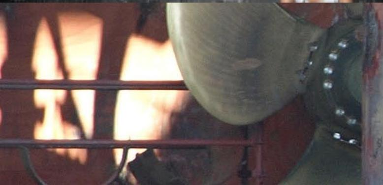
L'elica è di gran lunga il più diffuso organo di propulsione navale. Durante la sua rotazione l'elica spinge dietro di sé l'acqua ricevendo da essa una spinta che si trasferisce all'imbarcazione a cui l'elica stessa è solidale. L'efficienza di un'elica è ovviamente funzione del rapporto tra quanto lavoro compie e quanto se ne deve compiere per farla ruotare.
